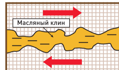
Жидкостное трение Внутреннее трение масла, гидродинамическая несущая способность масла.
